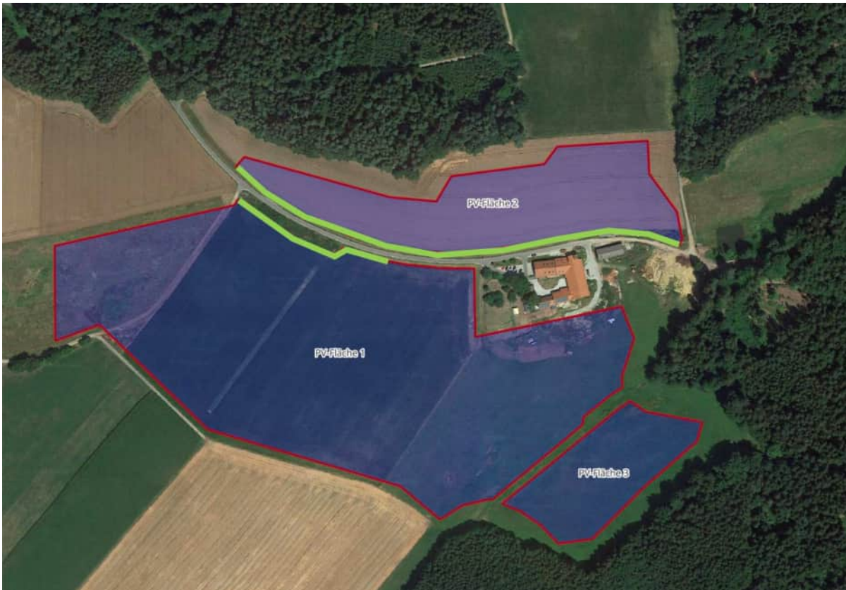
Abbildung: Position einer möglichen Eingrünung zur Minimierung der Blendwirkungen auf die Anbindung zum Hof zwischen den PV-Feldern – Quelle: Blendgutachten Büro SONNWINN
